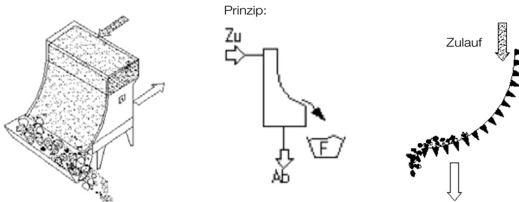
Drehsieb NOVASCREEEN (Ausführung für Durchsatz ab 50 m<sup>3</sup>/d)
